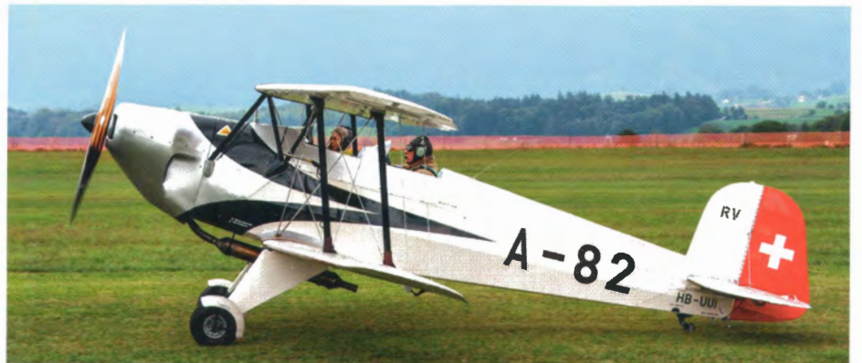
Der Bücker Bü 131 APM Jungmann A-82/HB-UUI mit Lycoming-Motor und MT-Propeller wurde kürzlich von Grund auf restauriert und hatte in Thun Premiere an einem Bücker-Treffen. Seine Bemalung erinnert an die Bückerbemalung der Schweizer Fliegertruppe, hebt sich aber mit seinem weissen und metallenen Grundanstrich vom originalen «Bücker-Gelb» mit schwarzen Streifen ab.
